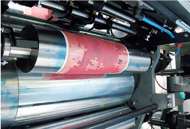
Flexodruckwerk für Außendruck
