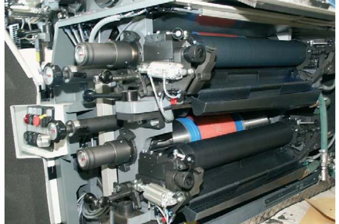
Flexodruckwerke für Außendruck
