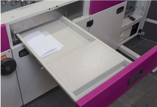
Entnahme einzelner Umschläge zur Qualitätssicherung
