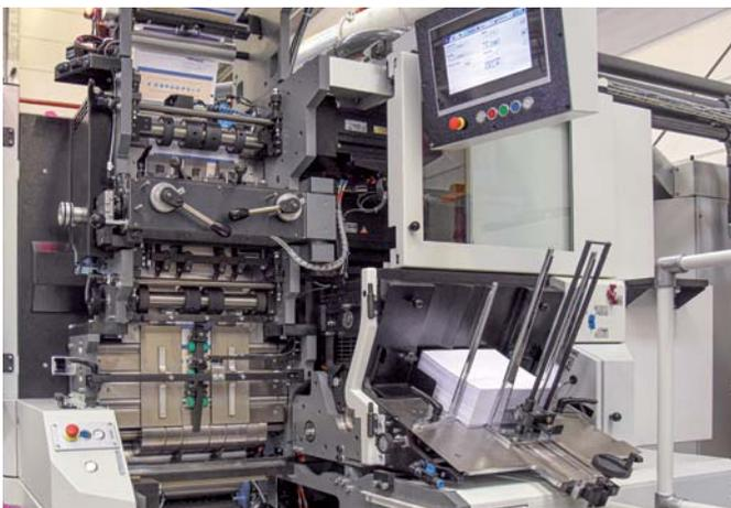
Schneideturm mit Station für Trennschnitt
