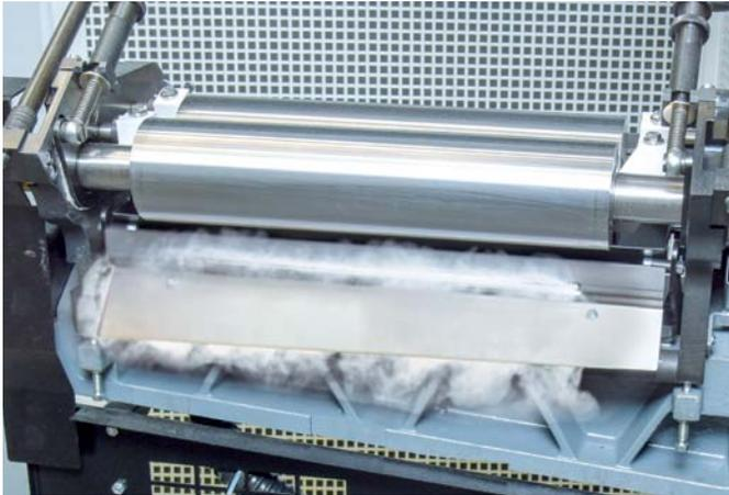
Schlußklappengummierwerk mit Leimbefeuchtung
