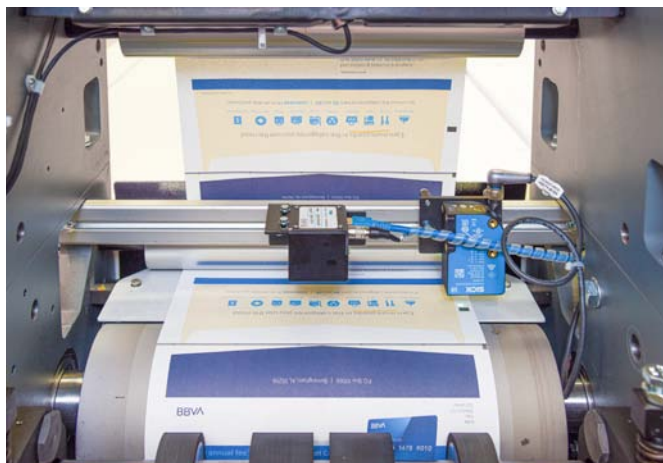
Caméra intelligente à l'entrée de la bobine dans la tour de coupe
