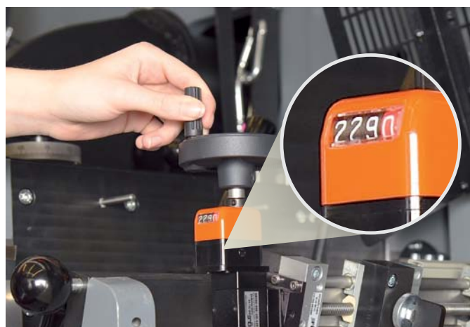
Adaptation facile et simple des formats d'enveloppes grâce à des aides de réglage intégrées et des échelles
