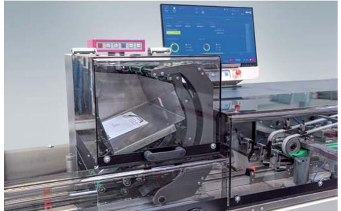
Système d'éjection dans la section d'assemblage
