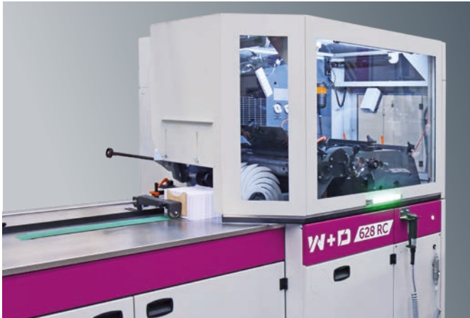
Lärmschutzverkleidung mit großen Fenstern zur Kontrolle des Produktionsprozesses
