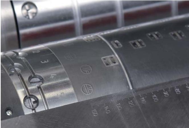
Les positions de vannes marquées sur la matrice de découpe EasyCut® permettent des changements simples et rapides
