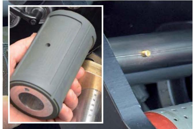
Positionnement sans outil du gommeur de fenêtre au moyen d'un système PIN
